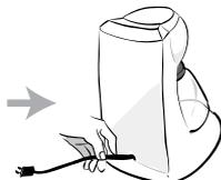
Para reduzir o comprimento do fio: Pegue o fio, desencaixe-o do sulco e depois o guie até o interior da cafeteira. Prenda o fio no sulco quando terminar esta operação.
